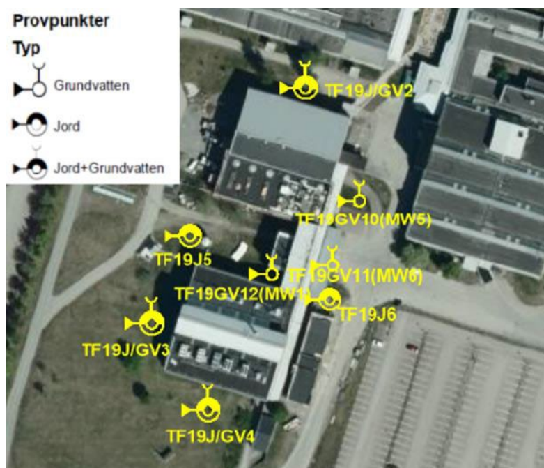
Bild 32 Metaller över riktvärdet för känslig markanvändning (KM) påträffas i punkterna TF19J/GV4, TF19J/GV2 och TF19J7 (kobolt) samt TF19J/GV2 (nickel). Inga halter uppmättes över riktvärdet för mindre känslig markanvändning (MKM) som bedöms vara det styrande riktvärde för området.
