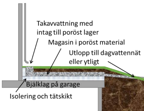
Figur 15. Principskiss på fördröjning av vatten på bjälklag.
