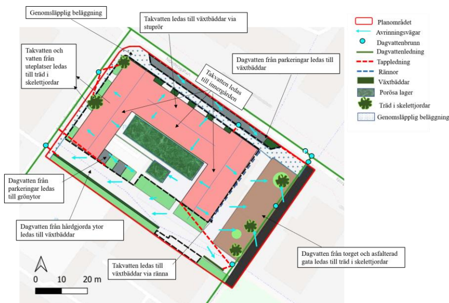
Figur 10. Schematisk skiss på hur dagvattenhanteringen kan lösas inom planområde med hjälp av växtbäddar, porösa lager på bjälklag, genomsläpplig beläggning och träd i skelettjordar. © Open Street Maps, bidragsgivare.
