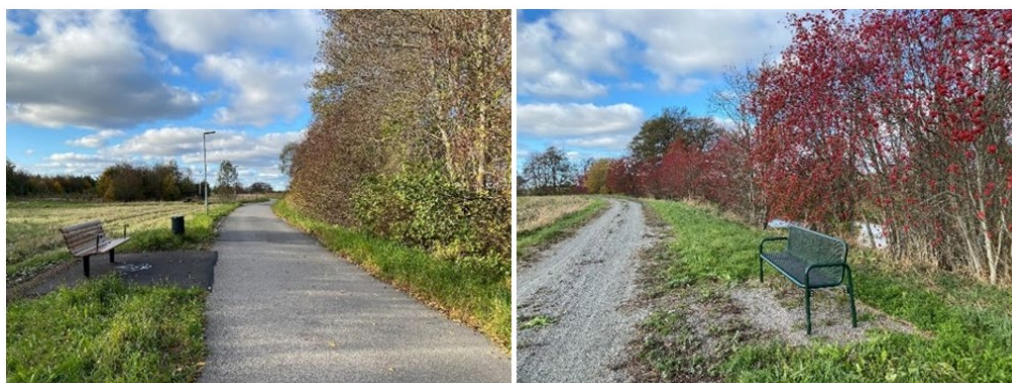
Figur 12 Exempel på utformning av gång- och cykelväg. Vänster bild visar den asfalterade och upplysta gång- och cykelvägen längs med Fyrisån mellan Tunabackar och Librobäck. Högerbilden visar den grusade gång- och cykelvägen mellan Ulva och väg 600.
