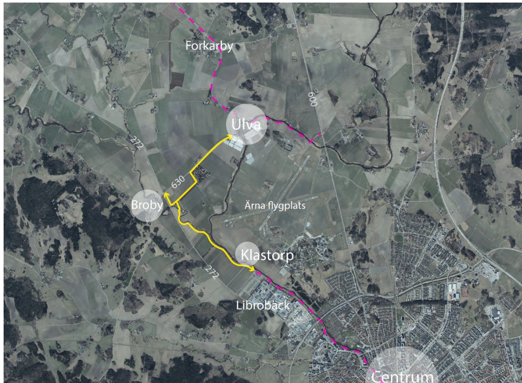
Figur 24 Flygfoto som visar befintliga gång- och cykelvägar i rosa streckade linjer och planerad gång- och cykelväg med gul linje.
