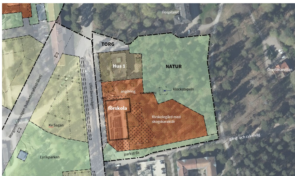
Bild 74 Utsnitt ur plankartan över förskoletomten som visar att förskolans byggrätt är närmast Ulleråkersvägen, på tidigare bebyggd mark och på avstånd från åskärnan. På förskolegården kommer det att finnas goda möjligheter till infiltration av rent dagvatten. Observera att kvarteret väster om förskolan ingår i Detaljplan för kvarteret Sagan med flera (2019).
