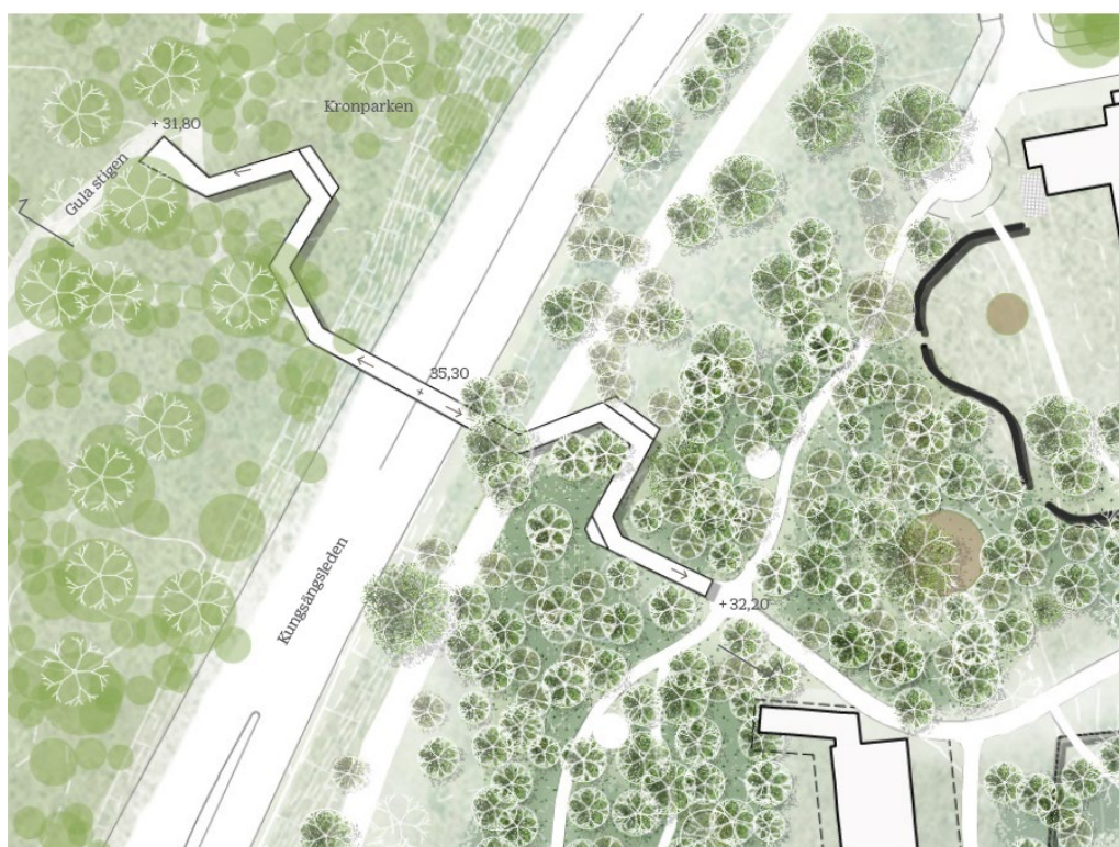
Bild 60 Planutsnitt över förslag till gångbro över Kungsängsleden. Exempel på utformning med slingrande ramper mellan träden. Illustration Nivå landskapsarkitektur
