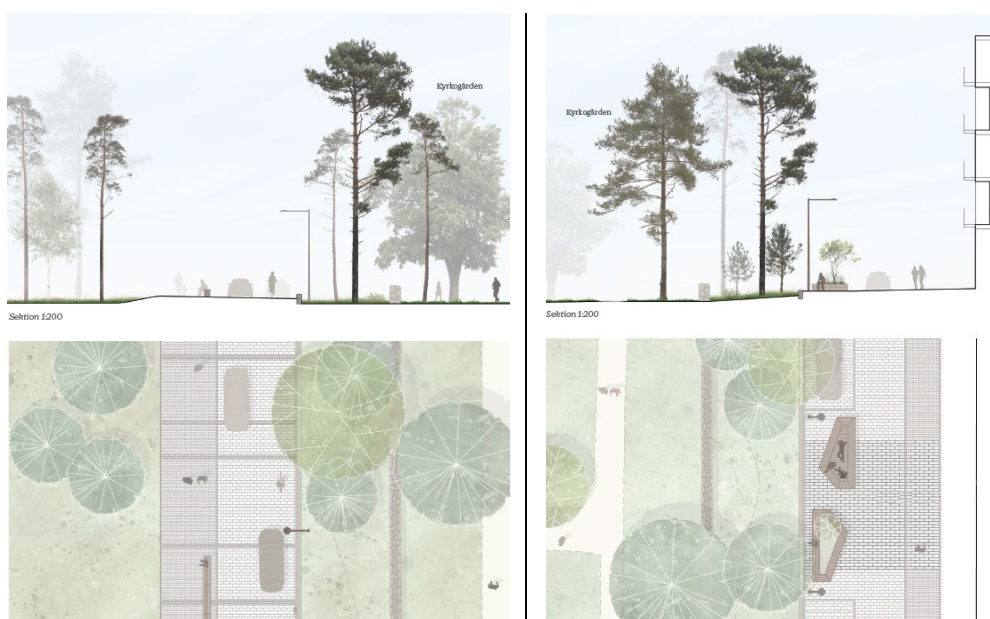
Bild 26 Sektion och planutsnitt över gatorna Levnadsfärden till vänster och Bernhard Jacobowskys väg till höger. Gatorna sträcker sig på västra respektive östra sidan om kyrkogården. Kyrkogården får en grön inramning med befintliga träd mellan gatan och kyrkogårdsmuren. Illustration Nivå landskapsarkitektur
