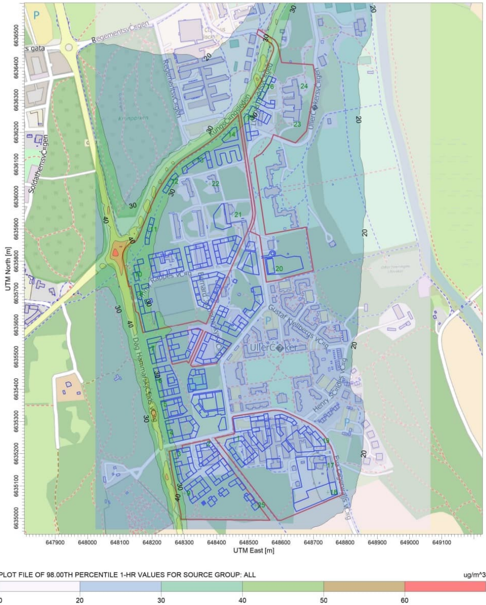
Figur 35 Beräknade halter av NO 2 [µg/m 3 ] som 98-percentil timme för planförslaget 2035 med spårvagn. De högsta halterna, 30 – 34 µg/m 3 , återfinns närmast och längs Kungsängsleden och Dag Hammarstiölds väg (receptor 3 – 16) men där miljömålet 60 µg/m 3 klaras överallt inom planområdet.
