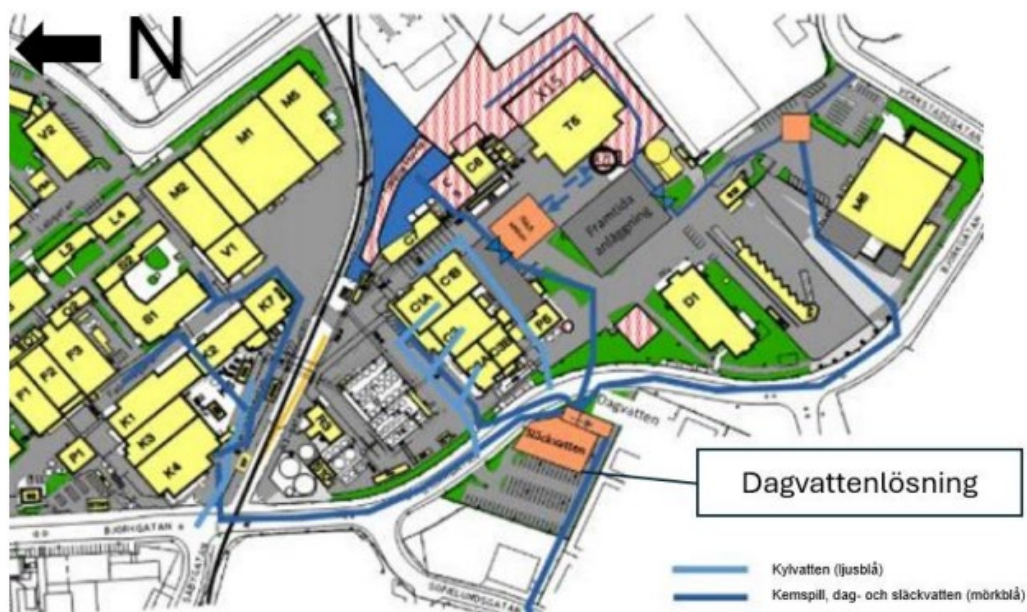
Figur 14 Kartbilden visar hur separation av dag- och kylvatten är tänkt att ske. Källa: Cytiva AB
