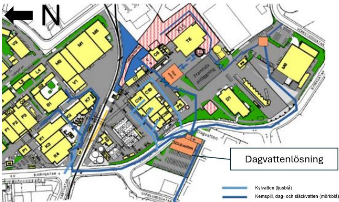
Figur 11. Separation av dag- och kylvatten. Bild tagen från prøvotidsredovisning, Cytiva 2021.
