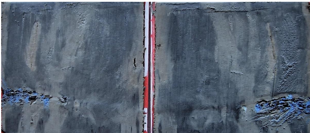
Figur 1 Borrpunkten, 22W03, 4,0 m, Jordprovet i nedre delen av mellanhylsan delad longitudinellt provhylsan med id Bjerking 1232.
