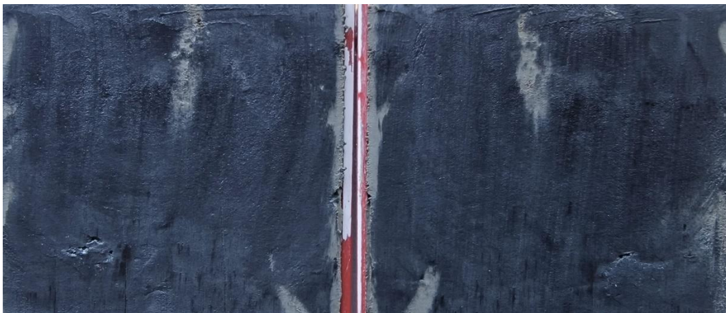
Figur 3 Borrpunkten, 22W03, 10,0 m, Jordprovet i nedre delen av mellanhylsan delad longitudinellt provhylsan med id Bjerking 1032.
