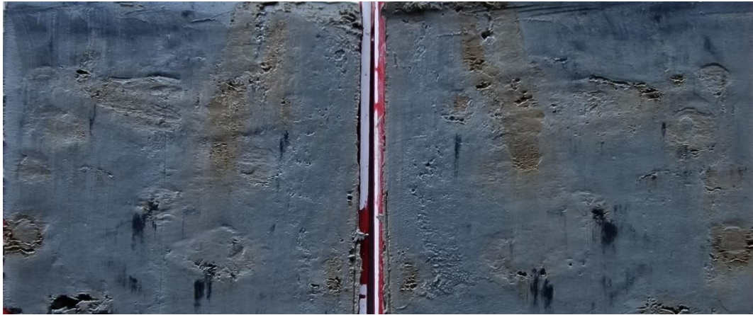
Figur 6 Borrpunkten, 22W08, 1,5 m, Jordprovet i nedre delen av mellanhylsan delad longitudinellt provhylsan med id Bjerking 747.
