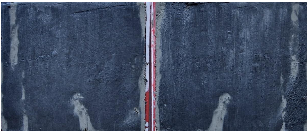
Figur 2 Borrpunkten, 22W03, 7,0 m, Jordprovet i nedre delen av mellanhylsan delad longitudinellt provhylsan med id Bjerking 1154.
