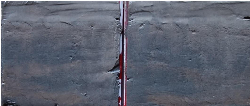
Figur 7 Borrpunkten, 22W08, 5,5 m, Jordprovet i nedre delen av mellanhylsan delad longitudinellt provhylsan med id Bjerking 1195.
