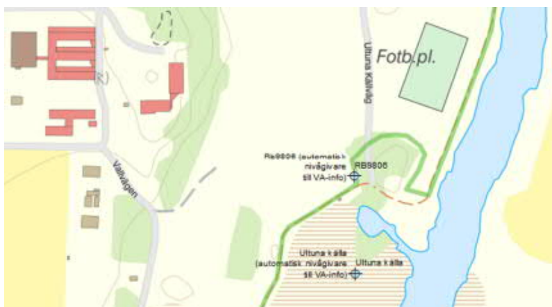
Figur 6.12. Placering av grundvattenrör Rb9806. I figuren syns också Ultuna källa där artesisikt grundvatten förekommer.
