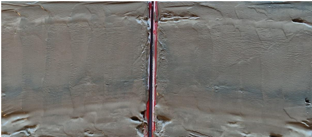
Figur 11 Borrpunkten, 23W023, 6,0 m, Jordprovet i nedre delen av mellanhylsan delad longitudinellt provhylsan med id Bjerking 1348.
