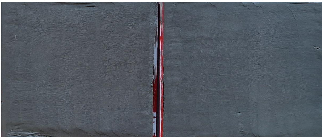
Figur 9 Borrpunkten, 23W021, 9,3 m, Jordprovet i nedre delen av mellanhylsan delad longitudinellt provhylsan med id Bjerking 914.
