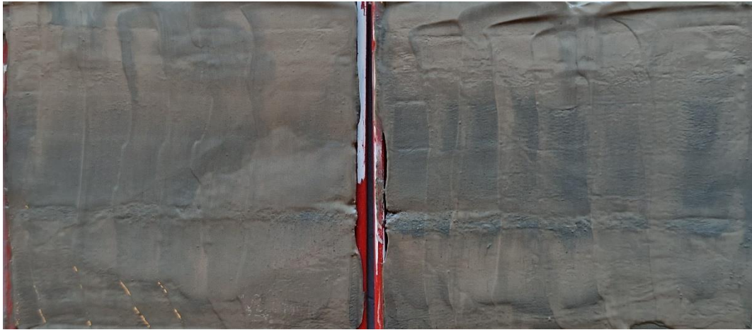
Figur 10 Borrpunkten, 23W023, 3,0 m, Jordprovet i nedre delen av mellanhylsan delad longitudinellt provhylsan med id Bjerking 1483.
