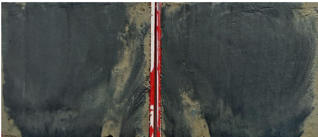
Figur 3 Borrpunkten, 23W009, 9,0 m, Jordprovet i nedre delen av mellanhylsan delad longitudinellt provhylsan med id Bjerking 940.
