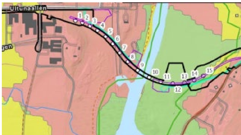
Figur 99: Föreslagna platser för brostöd i förhållande till mark med olika känslighet för påverkan på grundvattnet. Rött område betecknar mark med hög känslighet för påverkan. Grönt betecknar område
