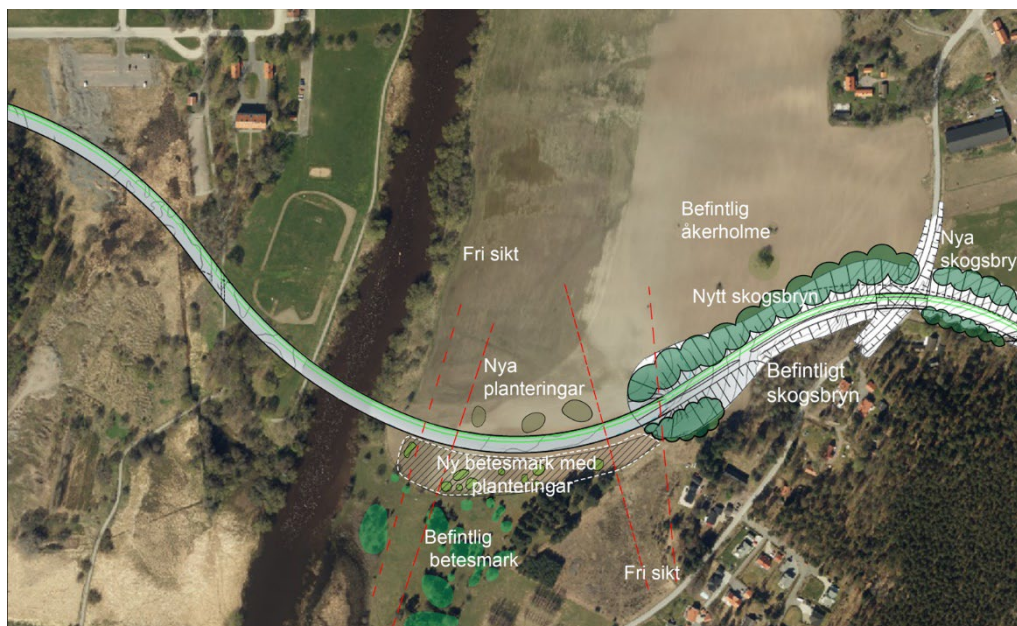
Figur 47: Bild som visar befintlig växtlighet och möjlig placering av tillkommande träd, dungar och skogsbryn samt område för ny betesmark. Röda streck visar möjliga siktlinjer mot norr. Bild: Bjerking, bearbetad av Uppsala kommun.
