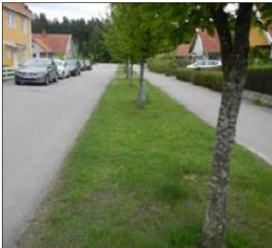
Exempel på infiltrationsytor för omhändertagande av dagvatten. (Bilder från dagvattenutredningen)
