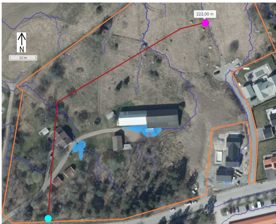
Figur 10. Profilers läge i plan (röd linje). Startpunkt i cyan, slutpunkt i magenta. Planområdet skissat i orange (ScalگوLive, 2024).
