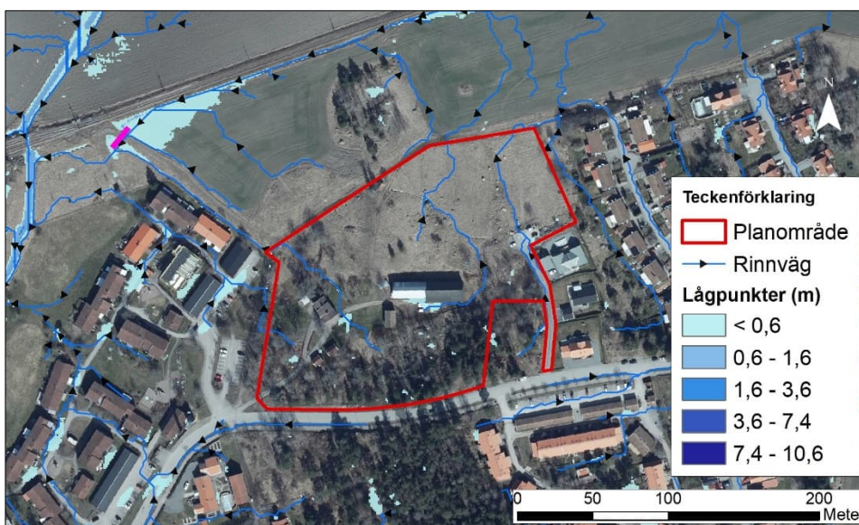
Figur 16. Vattendjup i lokala lågpunkter inom och i anslutning till planområdet vid kraftig nederbörd (68 mm, motsvarande ett 100-års regn med 60 minuters varaktighet och klimatfaktor 25 %). Lila markering indikerar trumma. Bakgrund: Ortofoto från Lantmäteriet.
