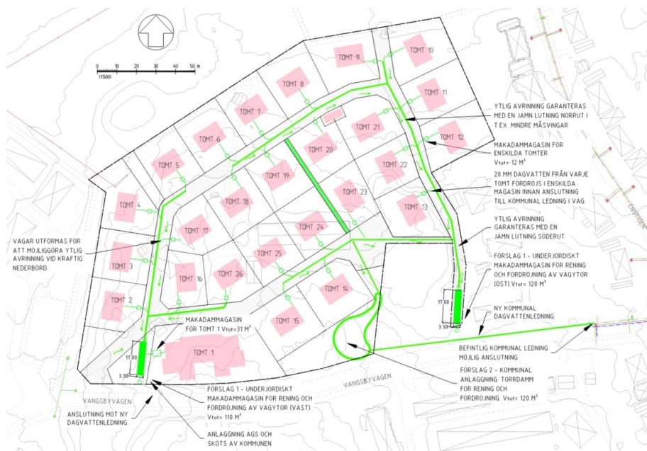
Figur 26. Principskiss för hantering av dagvatten med anslutning i syd. Skala 1:500.
