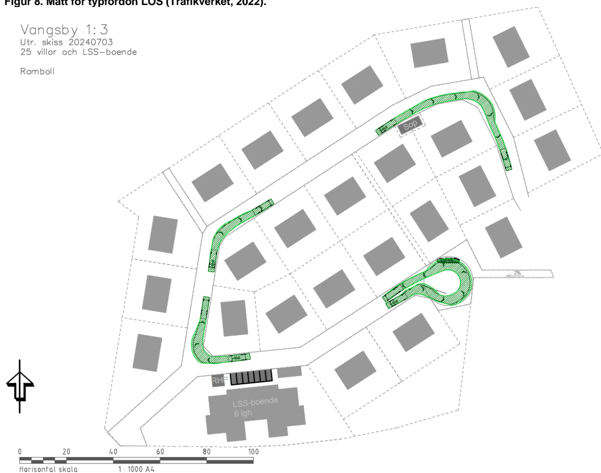
Figur 9. Körspårsanalys med typfordon LOS. Illustration: Ramboll.
