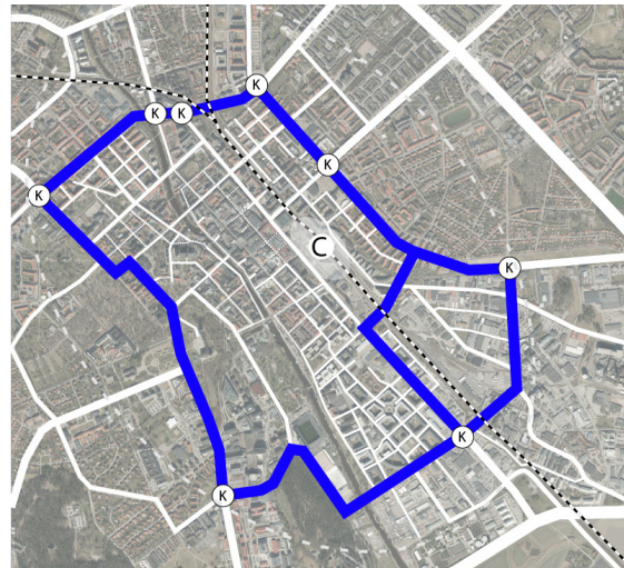
Figur 13 Kartan visar de inre ringgatorna. Viktiga dimensionerande korsningar pekats också ut, markerade med K
