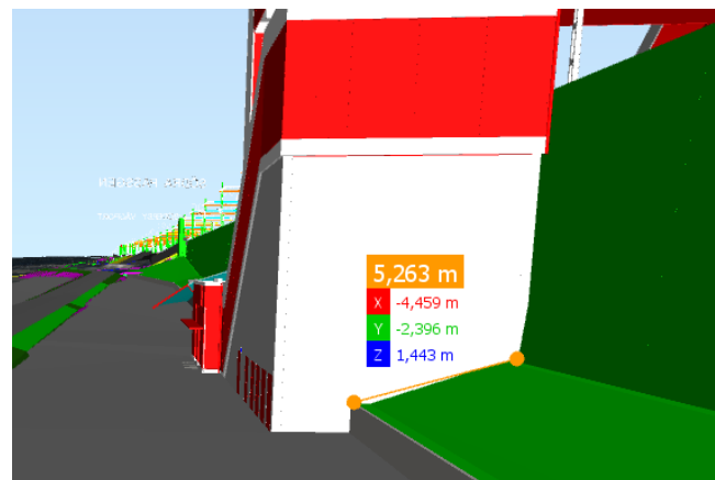
Bild från Trafikverkets modell visar den lägre landskapsmuren som krävs för grundläggning. Muren är cirka fem meter bred och har en lutning på 1:3 mot anslutande mark.
