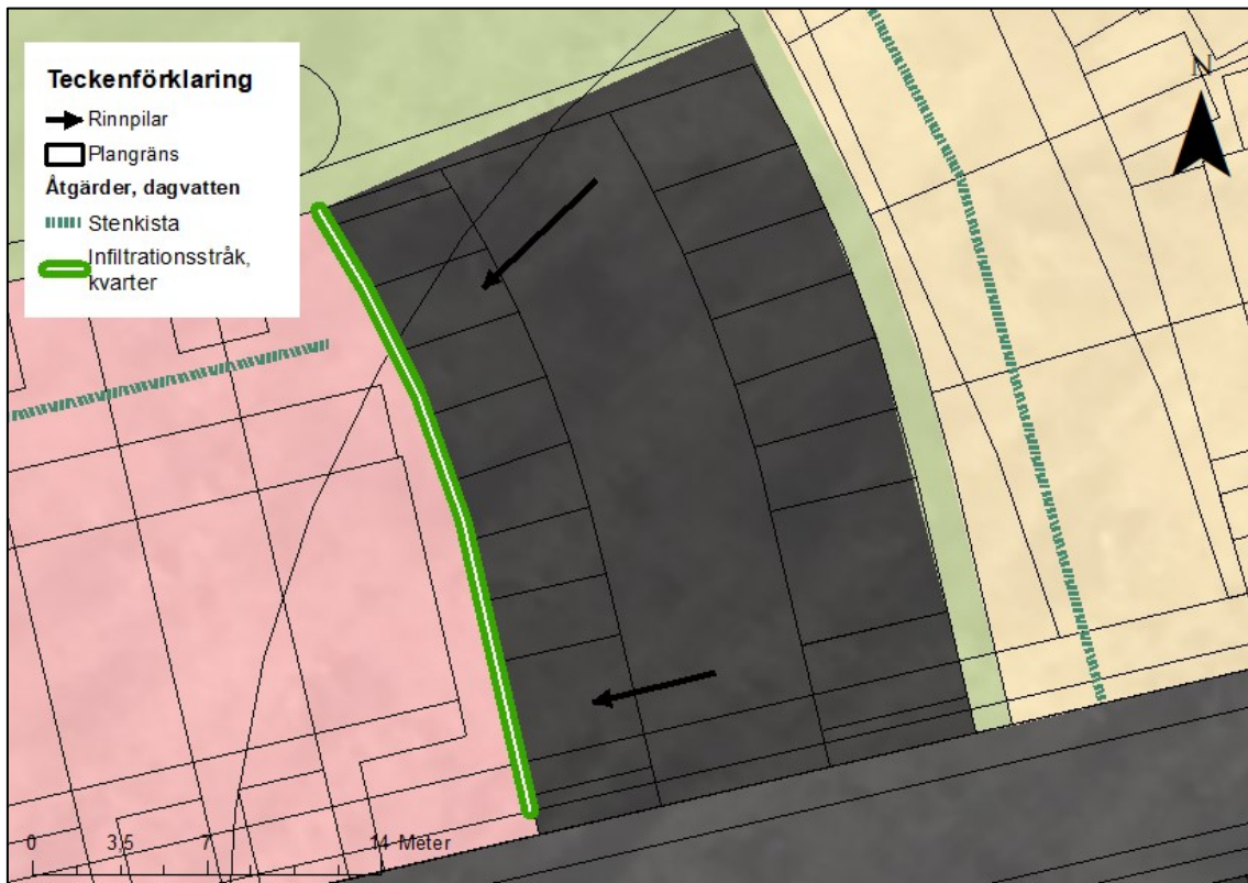
Figur 33. Exempel på avrinning till dagvattenstråk. Rinnpilar redovisas i svart.
