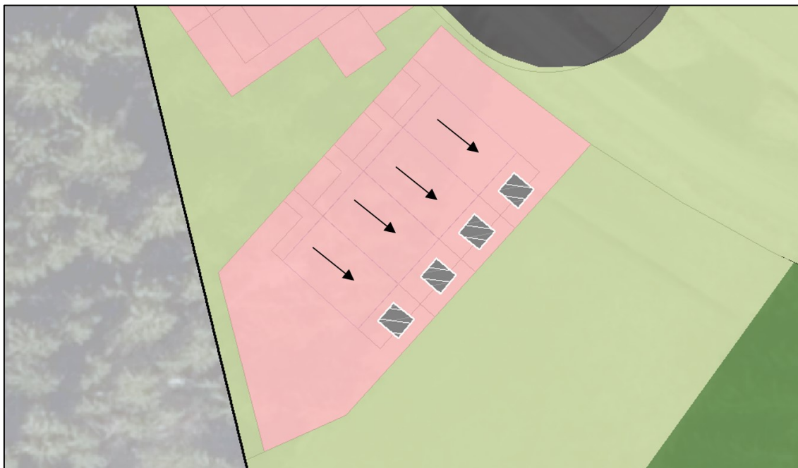
Figur 34. Schematisk placering av stenkistor på kvartersmark. Höjdsättning behöver anpassas för att möjliggöra avledning till stenkistorna. Rinnpilar redovisas i svart.
