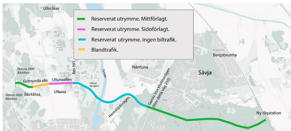
Figur 55: Illustration som visar förslag på spårvägens placering i gaturummet. Detta styrs dock inte i detaljplanen men detaljplanens gränser baseras på förprojekteringen för spårväg, där spårvägens placering i förhållande till biltrafiken varierar utmed sträckan beroende på platsens förutsättningar.
