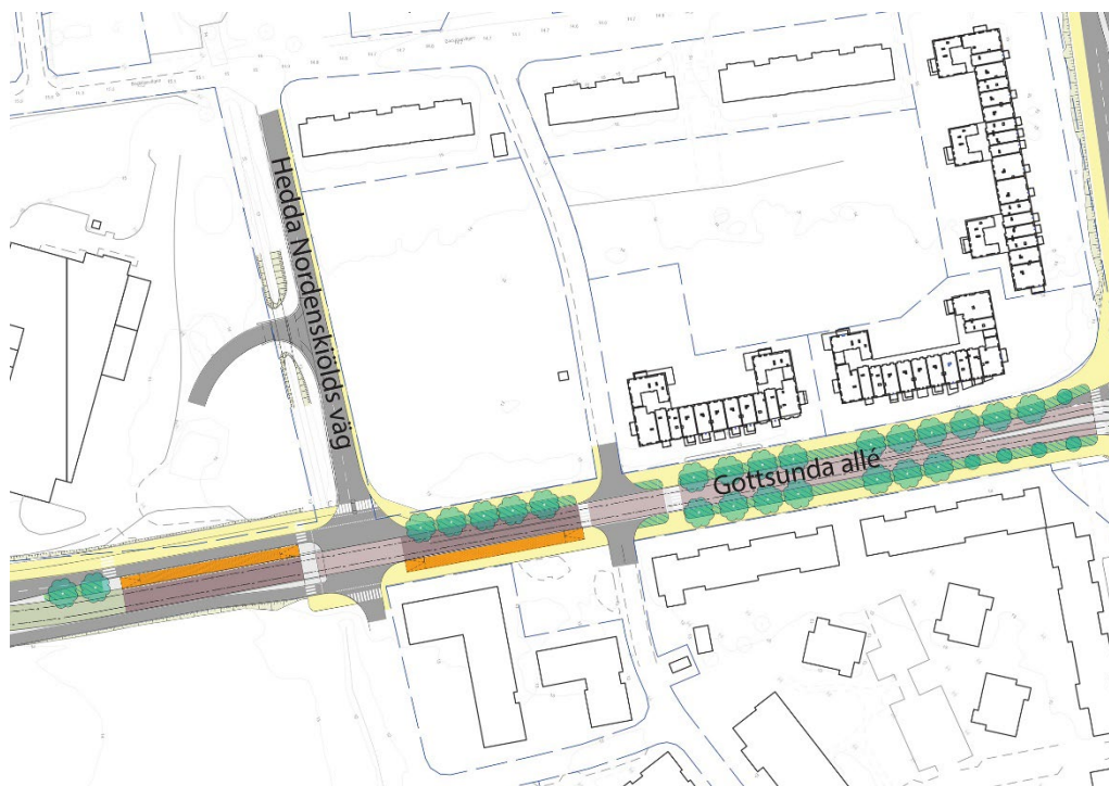
Figur 9: Illustration av Gottsunda allé. Hållplatslägen illustreras med orange vid korsningen med Hedda Nordenskiölds väg. Dag Hammarskjölds väg skymtar längst till höger. Ny infart till Bäcklösa vattenverk illustreras i mitten på Hedda Nordenskiölds väg. Bild: White arkitekter, redigerad av kommunen.
