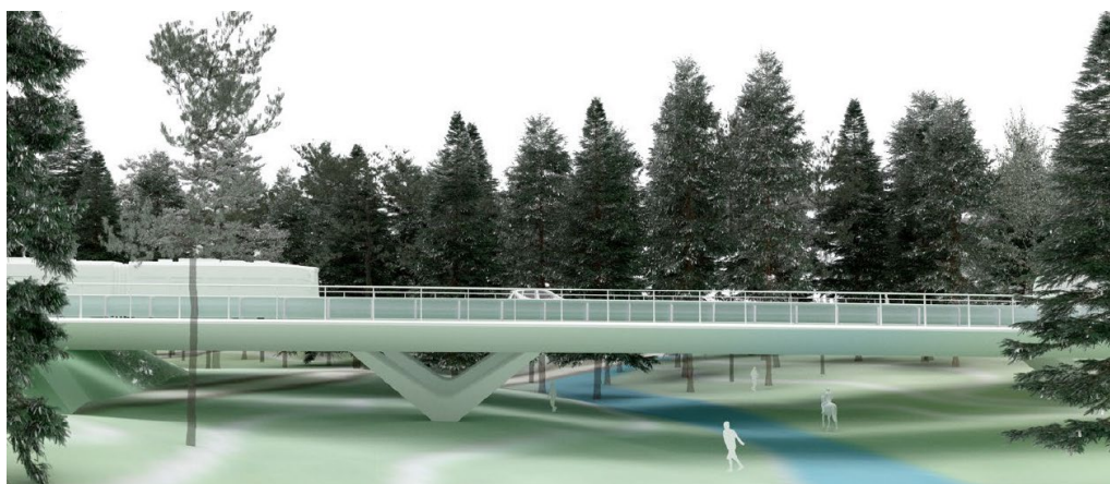
Figur 72: Illustration av möjlig utformning av faunapassagen. Stordammens utlopp som passerar under bron måste inte anpassas utan ska gå i befintlig sträckning. Bron ska vara minst tre och en halv meter hög över marken, vilket regleras på plankartan. Bild: Rundquist arkitekter.
