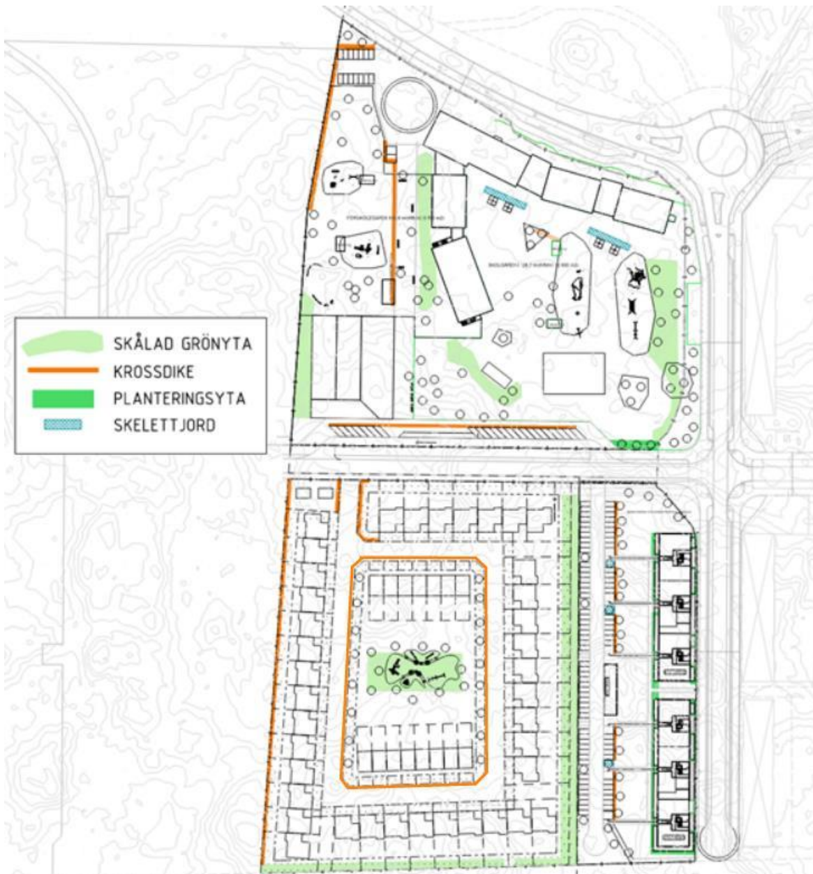
Figur 5-6. Princip för kvartersmarkens avvattningsystem
