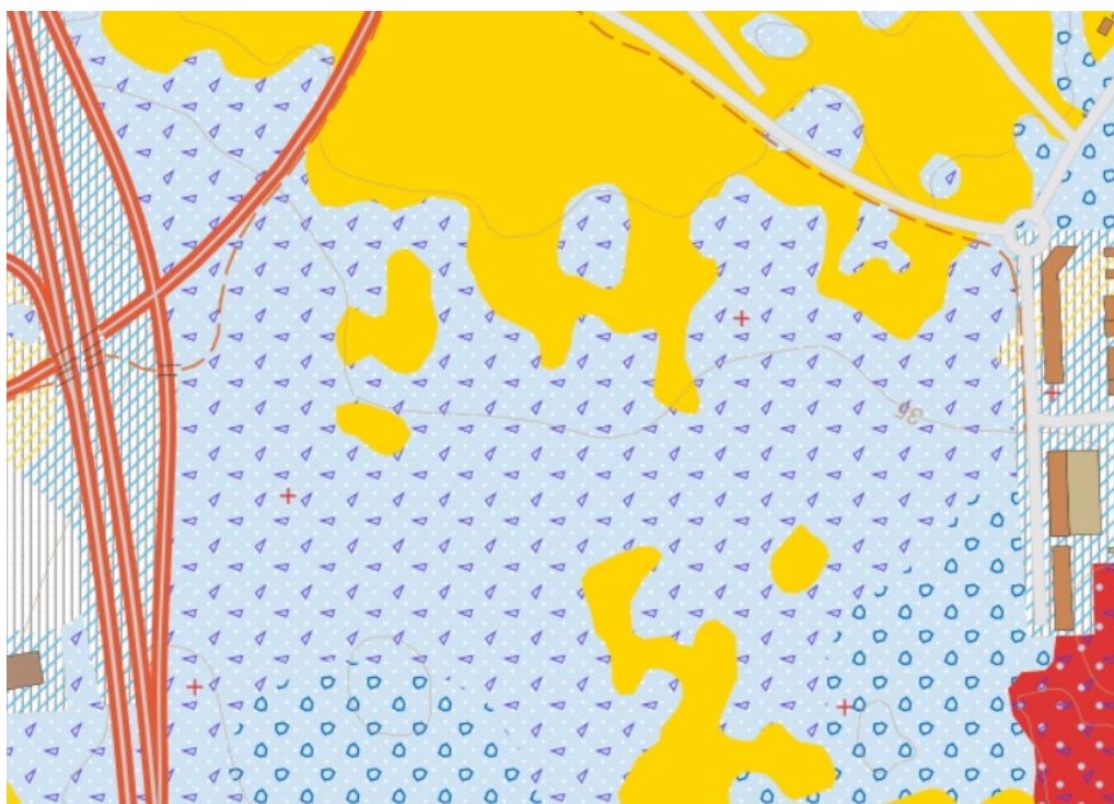
Figur 12 Jordartskarta hämtad från Sveriges geologiska undersökning (SGU). Planområdet består huvudsakligen av sandig morän (ljusblå yta med vita prickar) och blockrika ytor (lila polygoner).
