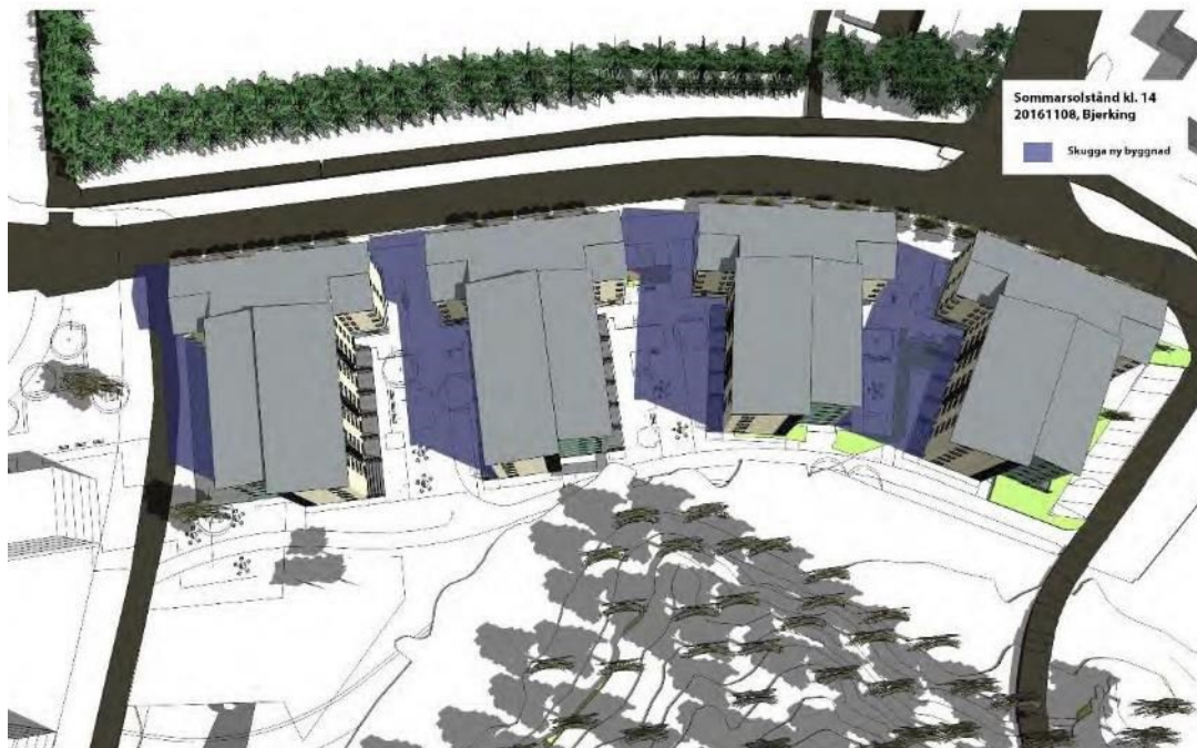
Solstudie som visar skuggpåverkan (lila färg) på de föreslagna husens innergårdar klockan 14 vid sommarsolstånd. Bjerking AB.
