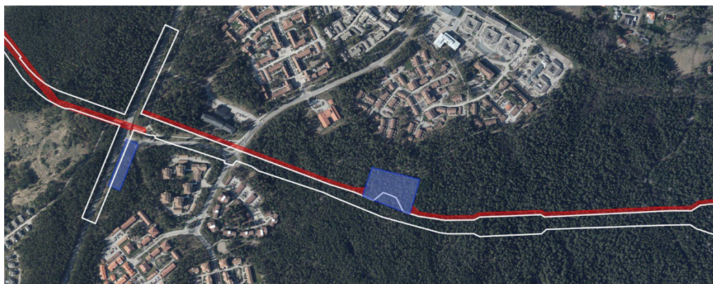
Figur 105: Illustration över planområdet och planerade etableringsytor vid spårvägens korsning med Gamla Stockholmsvägen. Planområdet illustreras med vit linje och etableringsytorna med blå färg. Arbetsvägarna visas med röd färg.
